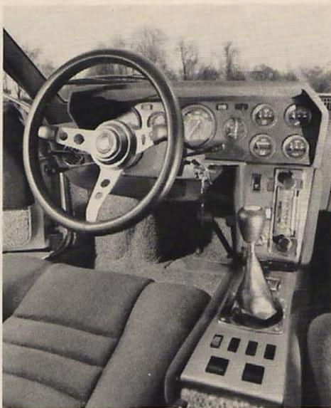
haglich eingerichtet, doch sehr eng. Hinter dem griffigen Lederlenkrad liegen übersichtlich die Instrumente, alle Schalter und Hebel befinden sich auf der Mittelkonsole.
